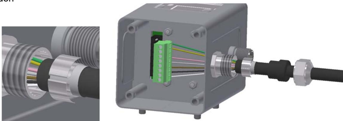
Kabel zurückziehen und Kontaktfeder auf den Außenschirm stecken
