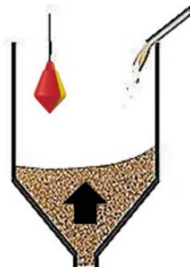
Wenn sich das Silo füllt, wird der Füllstandsensor vertikal aufgehängt.
