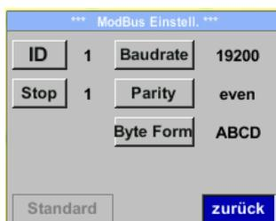
Um Änderungen, z.B. der Sensor ID, vorzunehmen, wird mittels Taste „**Δ**“ das Feld „**ID**“ selektiert und anschließend mit Taste „**OK**“ ausgewählt.
