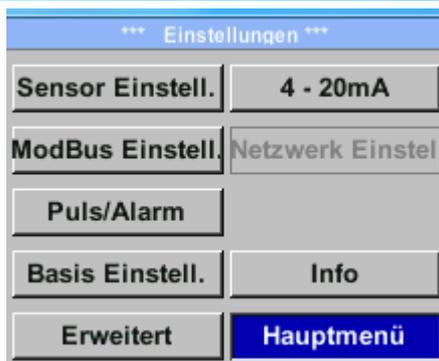
Einen Menüpunkt anzuwählen, Werte zu ändern muss die Taste „Δ“ bestätigt werden, die Menüpunktauswahl sowie die Werte Bestätigung erfolgt mit der Taste „OK“
