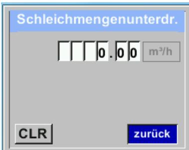
Die Schleimengenunterdrückung kommt in Anwendung um Verbrauchswerte unterhalb des definierten „LowFlow Cut off“ Wertes als  $0 \text{ m}^3/\text{h}$  anzuzeigen und auch nicht zum Verbrauchszählerstand zu addieren.
