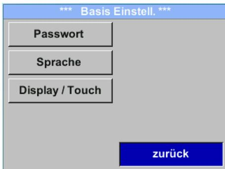
Um Änderungen vorzunehmen, zuerst einen Menüpunkt mit Taste „ $\Delta$ “ auswählen und anschließend mit Taste „**OK**“ auswählen
