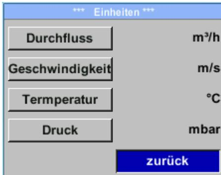
Um Änderungen der Einheit für den jeweiligen Messwert vorzunehmen muss mittels Taste „△“ das Tastenfeld des Messwertes angewählt werden und mit Taste „OK“ aktiviert werden.
