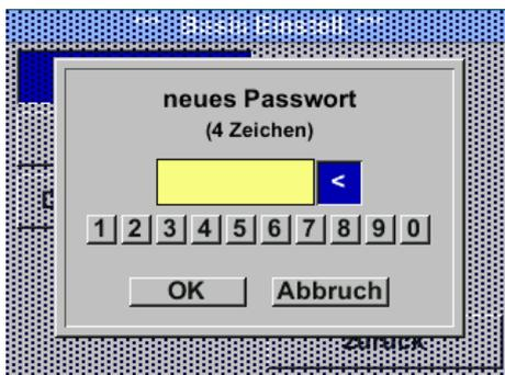
Es kann jederzeit ein/neues Passwort vergeben werden. Dies besteht immer aus 4 Zahlen welche mit Taste „ $\Delta$ “ ausgewählt und anschließend mit Taste „**OK**“ bestätigt werden. Mit Taste „ $\Delta$ “ wird jeweils letzte Ziffer gelöscht.
