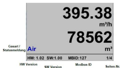
Das Umschalten auf die Seiten 2-4 erfolgt mittels Taste „  $\Delta$  “
