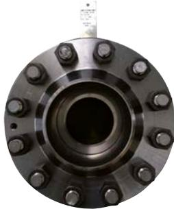
Druckentnahmen: Jeder Flansch verfügt serienmäßig über 2 x 1/2" NPT und um 180° versetzte einzelne Entnahmen mit einem Stopfen. Der Durchmesser der Entnahmeöffnung ist 1/4" für Größe 2" und 2 1/2", 3/8" für Größe 3", 1/2" für Größe 4" und größer.
