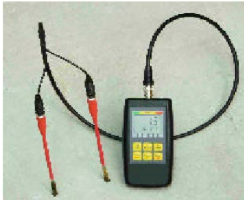
Betonmessung mit Bürstensonden
