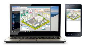
Form von integrierten oder vom Benutzer erstellten Websites. Zusammen mit dem Gerät liefert der Hersteller eine Reihe von eingebauten visuellen Komponenten (Widgets), die unter Verwendung des HTML5-Protokolls den Programmierern einfache Mechanismen zum Abrufen von Daten aus dem Gerät sowie gebrauchsfertige Formate für die Datenpräsentation auf dem Computer-, Tablet- oder Mobiltelefon-Bildschirm bieten.
