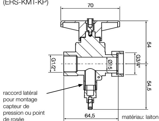
raccord latéral pour montage capteur de pression ou point de rosée
