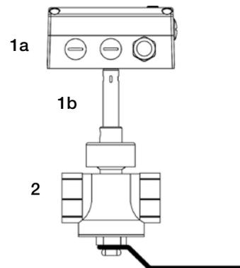
Le montage du robinet à boisseau sphérique permet le montage et le démontage précis et fi dèles de la tête de la sonde en quelques secondes avec une interruption minimale du flux.
