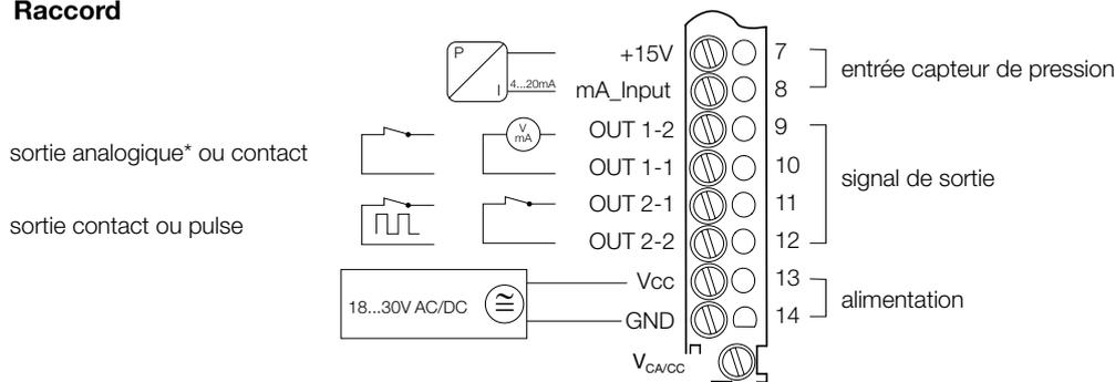
\* Pour les sorties analogiques OUT 1-1 est connecté avec GND. Les sorties relais et à impulsion sont libres de potentiel.
