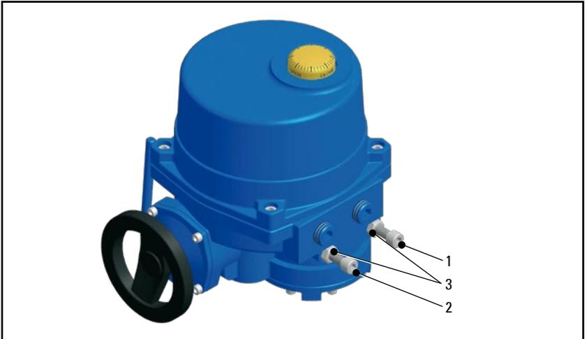
Abb. 7.3 -Einstellung der mechanischen Endanschläge
