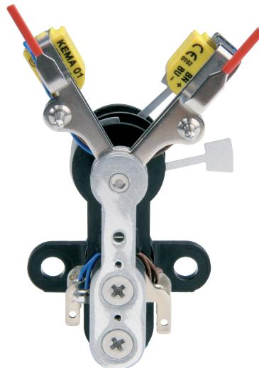
Indukční kontakt se skládá z řídicí hlavice (iniciátor) s indikátorem spínané hodnoty s kompletně zalitou elektronikou a mechanické nadstavby s pohyblivým kontrolním praporkem. Kontrolním praporkem hybe ručička přístroje ukazující aktuální hodnotu tlaku. Řídicí hlavice je napájena stejnosměrným napětím.
