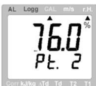
Stecken Sie die Sonde in die entsprechend vorbereitete Kalibriervorrichtung mit dem zweiten Feuchtwert. Voraussetzung: Hatte der erste Wert weniger als 50 %, muss dieser Wert über 50 % liegen bzw. umgekehrt. Ansonsten gleiche Vorgehensweise wie bei Kalibrierpunkt 1. Wenn die Anzeige nicht mehr blinkt und wechselt, kann der Messwert mit "Store" (Taste 6) übernommen werden, die Kalibration ist beendet.
