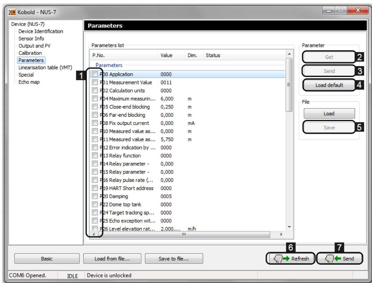
Um die werkseitigen Standardwerte zu laden, klicken Sie auf die Schaltfläche Load Default. Daraufhin erscheint ein 'warning'- Fenster, in dem Sie das Laden der Standardwerte bestätigen oder abbrechen können.
