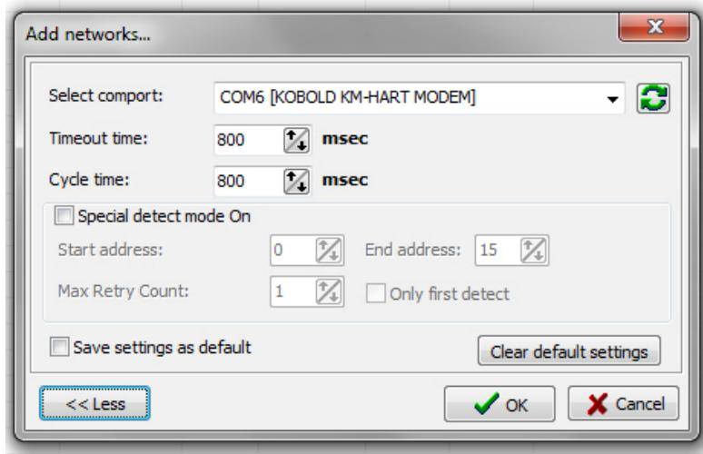
Aktivieren Sie Special Detect Mode On, um die speziellen Einstellungen des zu ändernden Erkennungsmodus zu aktivieren. Die speziellen Einstellungen werden in der folgenden Abbildung beschrieben:
