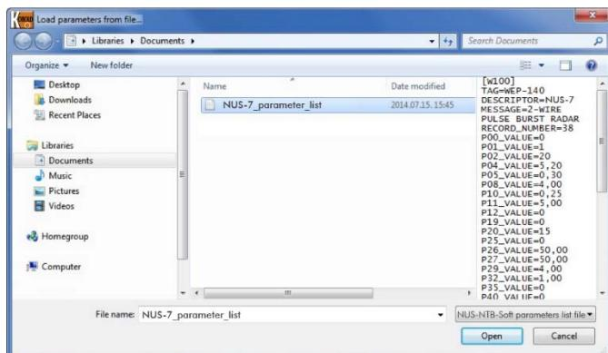
Die Software wertet die Parameterwerte während des Ladens automatisch aus und prüft, ob die Werte innerhalb des zulässigen Bereichs liegen und markiert die Elemente, die einen falschen Wert haben.
