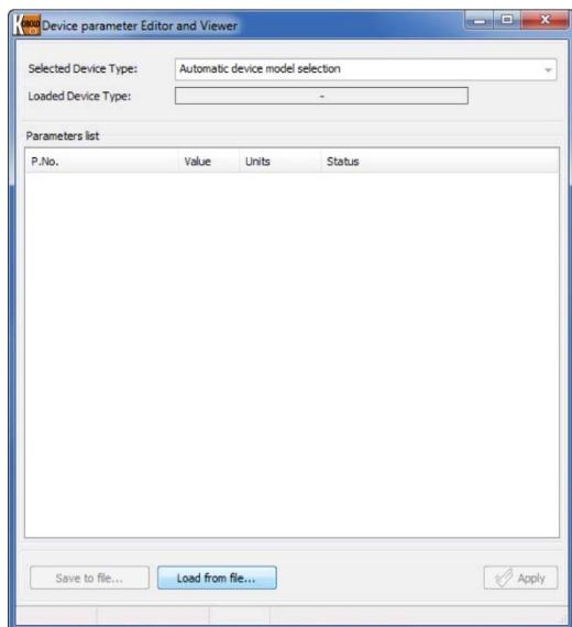
Durch Anklicken der Schaltfläche 'Load From File...' erscheint ein Browserfenster, in dem eine zuvor gespeicherte Parameterlistendatei durchsucht und durch Anklicken der Schaltfläche 'Open' geöffnet werden kann.
