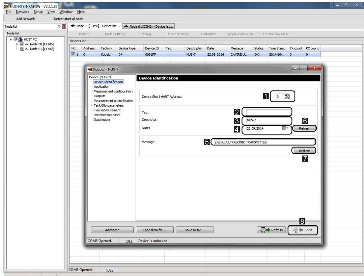
In diesem Fenster werden die gerätespezifischen Einstellungen angezeigt. Das Fenster besteht aus zwei Hauptteilen, auf der linken Seite befindet sich ein Navigationsbildschirm und auf der rechten Seite sind die änderbaren Einstellungen aufgelistet.
