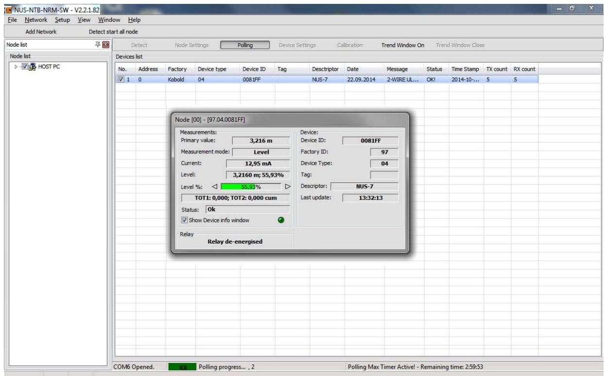
Wenn die Schaltfläche Polling angeklickt wird, wird die Abfrage gestartet und es erscheint ein kleines Fenster, in dem die kontinuierliche Abfrage der Messdaten beginnt. Das maximale Zeitintervall des Pollings beträgt 3 Stunden und die verbleibende Zeit wird in der unteren Statusleiste angezeigt. Um die Messdatenabfrage zu beenden, klicken Sie erneut auf die Schaltfläche Polling.
