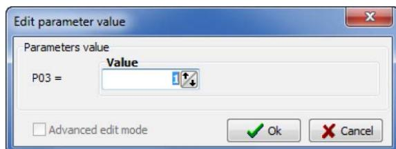
Dieses Fenster bietet die Möglichkeit, einen Parameterwert gemäß dem Benutzer- und Programmierhandbuch des jeweiligen Senders zu ändern. Klicken Sie auf die Schaltfläche 'OK', um den Wert zu ändern. Wenn Sie die Taste 'ESC' drücken oder auf die Schaltfläche 'Cancel' klicken, wird der Parameterwert nicht geändert.
