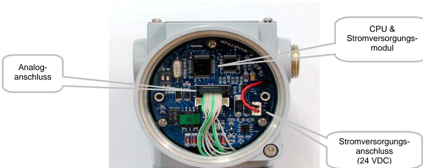
**Abbildung 8.3: Aufbau des Elektronikmoduls im Inneren des Messumformers**
